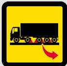
> Αφαιρέστε τη σφήνα και τοποθετήστε τη σε μια θήκη
